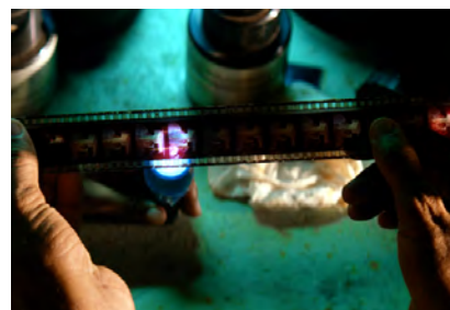
Der Filmvorführer hält einen 35mm-Filmstreifen über eine kleine Lampe. Man kann die einzelnen Bilder, aus denen der Film besteht, gut erkennen. (© Neue Visionen)
